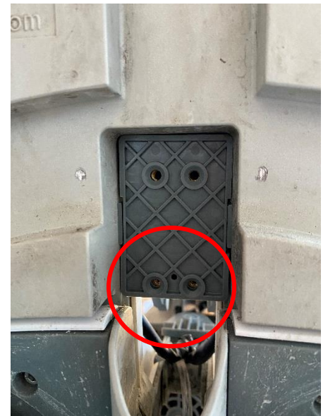
Placer pladen på undersiden. Det lille hul skal være nederst.
