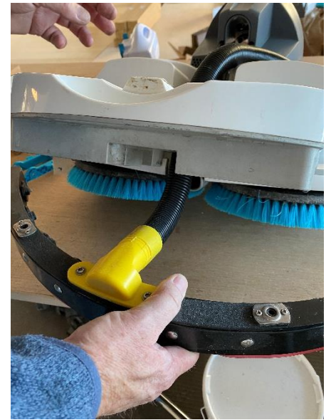
Afmonter sugeslange fra sugefod. Fjern sugefod fra maskinen.
