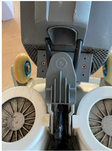
Den gamle trækkes op og den nye trykkes på plads med hånden.
