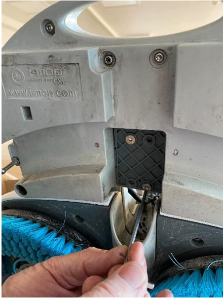
Monter med fire medfølgende skruer.
