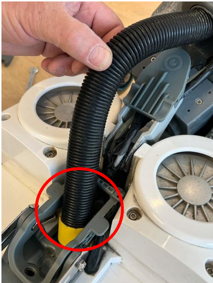
Sugeslange monteres ned gennem drive support.
