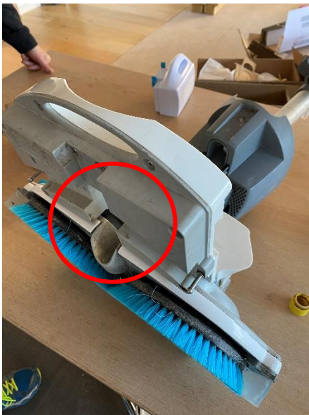
Fjern sugeslangen fra maskinen.
