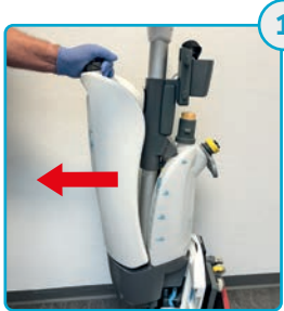
Tag snavsevands- tanken af Remove the dirt tank
