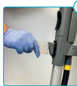
Tag deflektoren ud Remove the deflector
